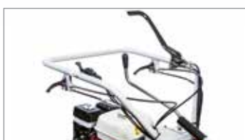
Dirección con desbloques y frenos independientes.
