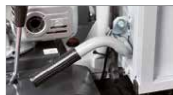
Basculamiento manual con sistema de bloqueo automático.
