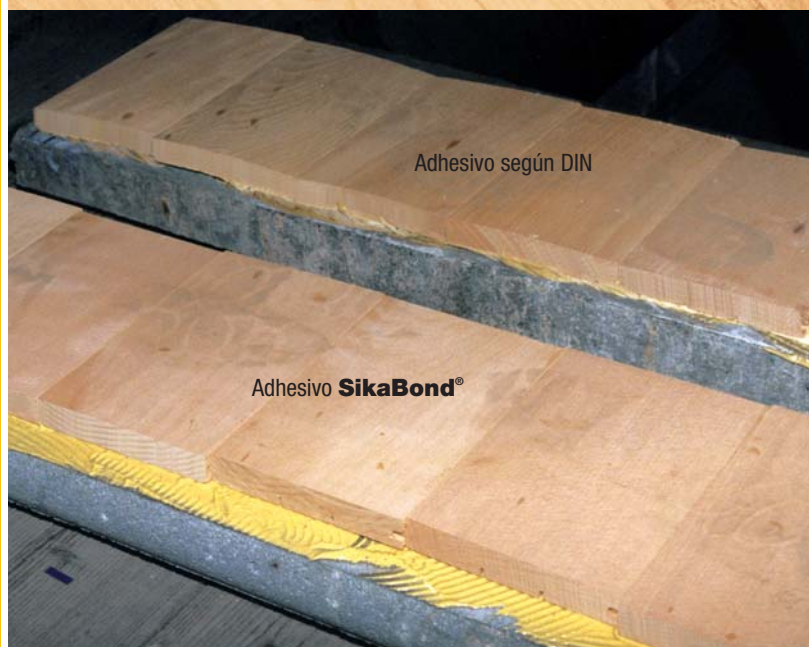
Fig. 5: Ensayo bajo condiciones extremas: tabla de 21 mm de espesor de madera de haya con un 22% de contenido de humedad
