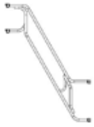
| Parapeto/Barandilla central escalera
