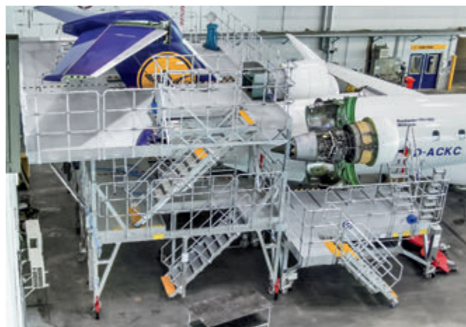
Dock de cola y motores regulable en altura para Bombardier CRJ900.
