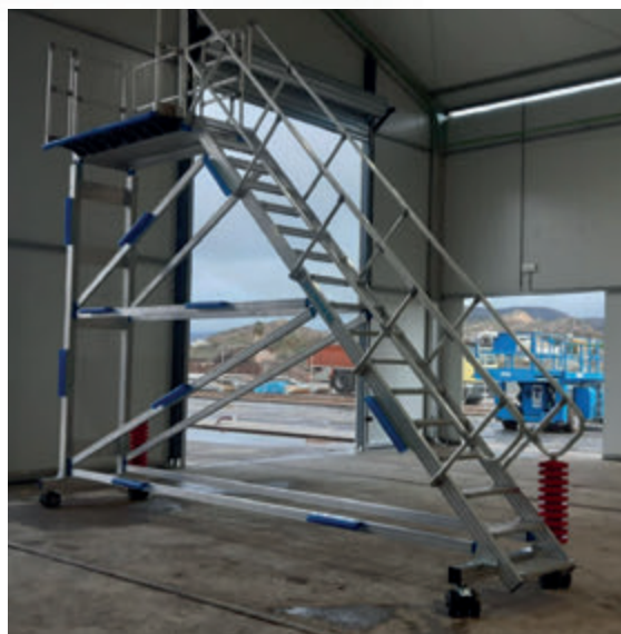
Escalera de plataforma para acceso a techo.
