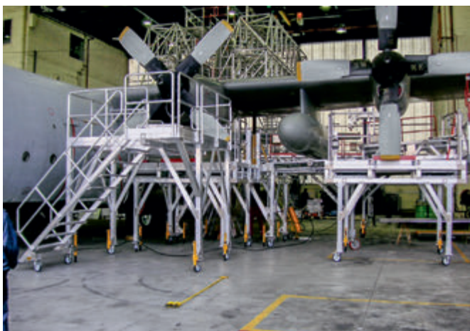
Dock de motores y hélices para C130 Hercules.
