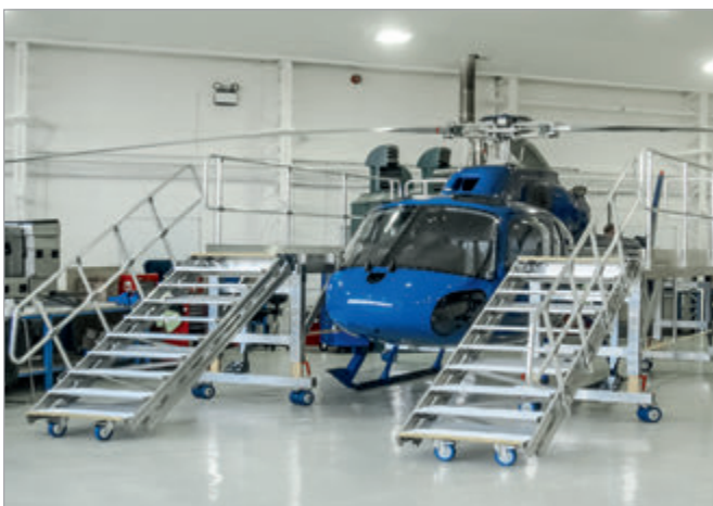
Plataforma de mantenimiento regulable en altura para EC 145.
