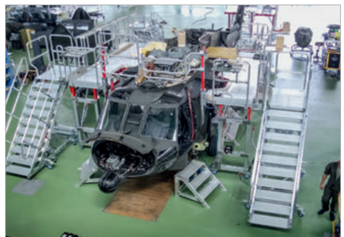
Dock system regulable en altura para Black Hawk.
