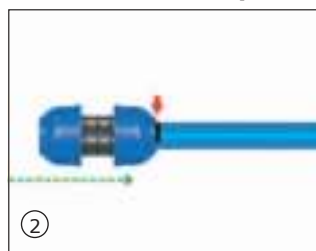
Inserción del accesorio hasta la señal
