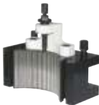
Vista trasera de porta-útil para cuchilla cuadrada (tipo D)
