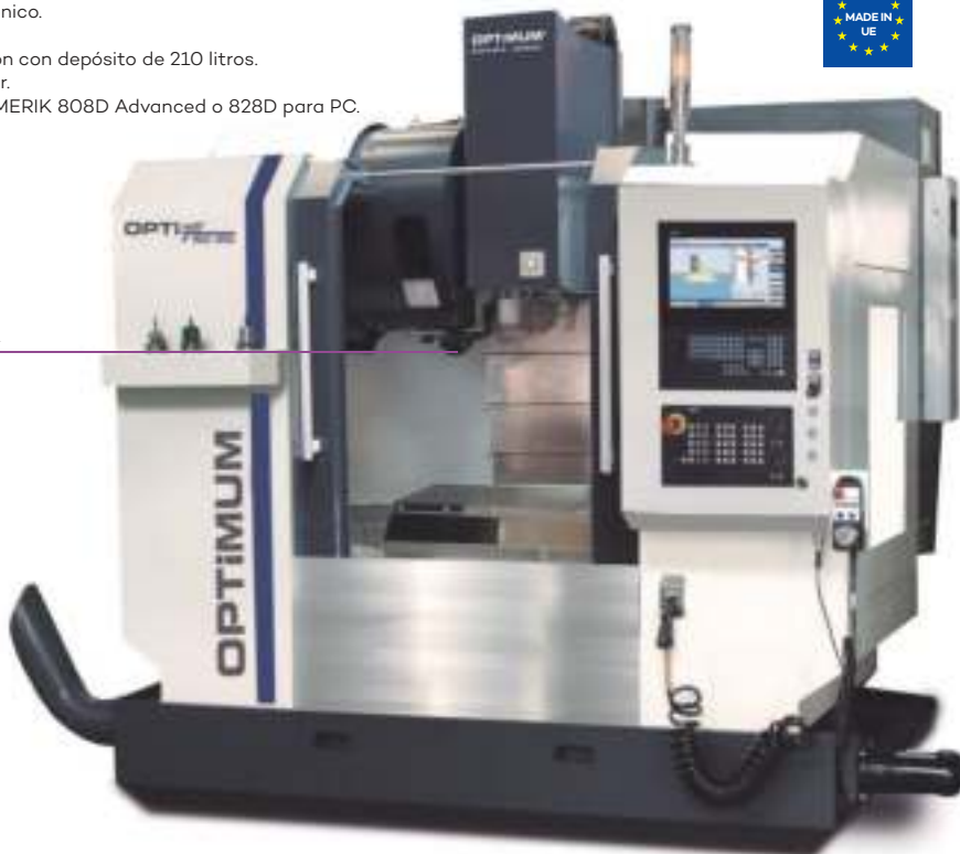
Cambio de herramientas · Automático con 24 ranuras.
