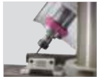
Cabezal · Inclinación lateral ±45°.
